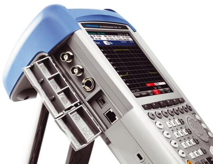
Рис. 3. Дополнительные разъемы, например, для подключения к интерфейсам LAN и USB, защищены крышками
