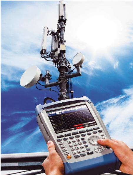
Рис. 1. Тестирование базовой станции беспроводной связи с новым портативным анализатором спектра R&S®FSH8
