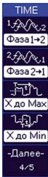
Рис. 2. Фрагмент экранного меню для выбора автоматических измерений во временной области цифровых осциллографов АКТАКОМ
