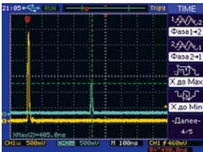
Рис. 7. Курсорные измерения задержанного (отраженного) сигнала с уменьшенным временем
