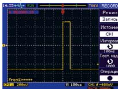
Рис. 10. Регистрация 15-го импульса (80 мкс) в режиме покадровой регистрации
