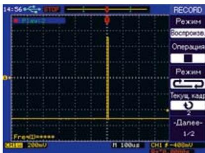
Рис. 12. Воспроизведение 2 импульса, записанного в режиме покадровой регистрации
