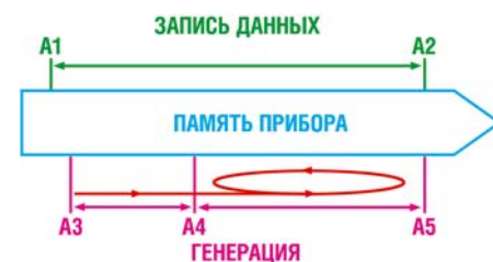
Рис. 5. Организация буферов чтения (А1 — начальный адрес записи данных во внутреннюю память прибора; А2 — конечный адрес записи данных во внутреннюю память прибора и конечный адрес памяти; А3 — начальный адрес генерации при первом цикле чтения памяти; А4 — адрес генерации при последующих циклах чтения памяти; А5 — конечный адрес генерации и конечный адрес памяти)
